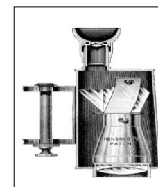
Neue Prismen Einstellvorrichtung nach DRP 118.256 (August 1900).
